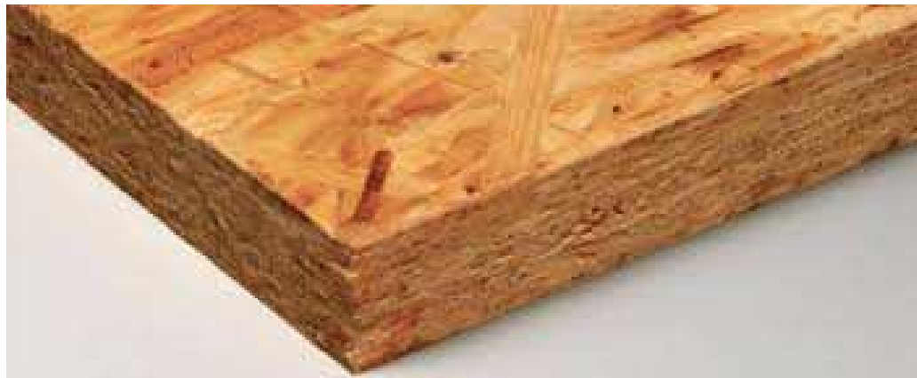
OSB (trucioli lunghi, stretti e orientati)
