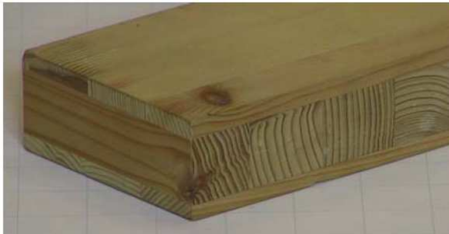
pannello di legno massiccio a tre strati
