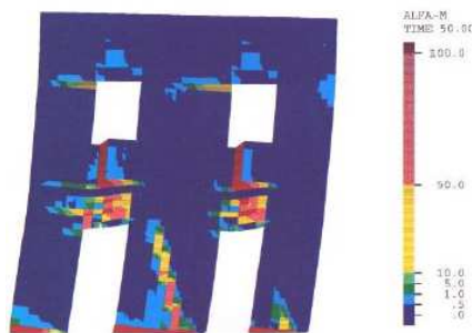
Analisi agli elementi finiti: distribuzione del danneggiamento nei giunti di malta
