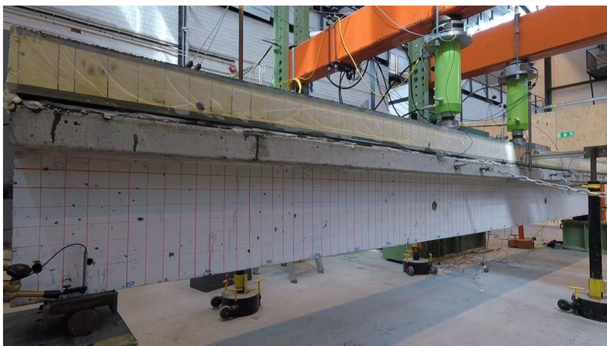
Fig. 9: Prova di laboratorio su una trave prototipo rinforzata / Laboratory test on strengthened prototype beam
