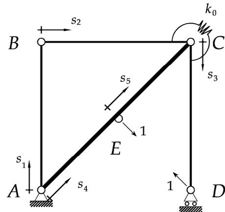
Le CdS nei vari tratti sono, nei due sistemi le seguenti (con  $s_1, s_2$  e  $s_3 \in [0, l]$  e  $s_4$  e  $s_5 \in [0, l/\sqrt{2}]$ ):
