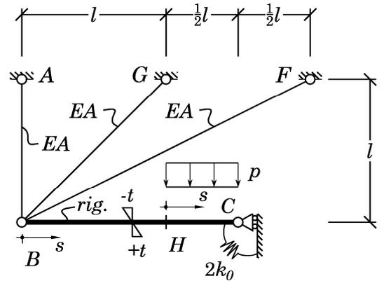
3) Il sistema ridotto può essere facilmente risolto anche mediante il metodo delle forze, scegliendo come incognita iperstatica  $X_1$  la reazione esercitata dall'appoggio in  $C$  e come incognita iperstatica  $X_2$  lo sforzo normale che l'asta  $BG$  applica al nodo  $B$ . E' tuttavia sufficiente:
