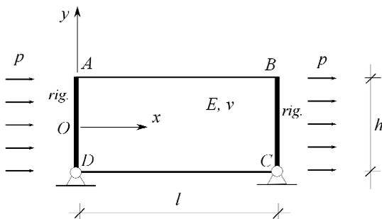
**Problema 1.** Nel problema piano nella tensione mostrato in figura, un elemento elastico rettangolare, di base  $l$ , altezza  $h$  e di spessore supposto, per semplicità, unitario, è vincolato lungo i lati  $AD$  e  $BC$  ad aderire perfettamente a due travi rigide. Le travi, a loro volta vincolate a un supporto fisso mediante due cerniere, sono soggette a un carico distribuito d'intensità uniforme uguale a  $p$ .
